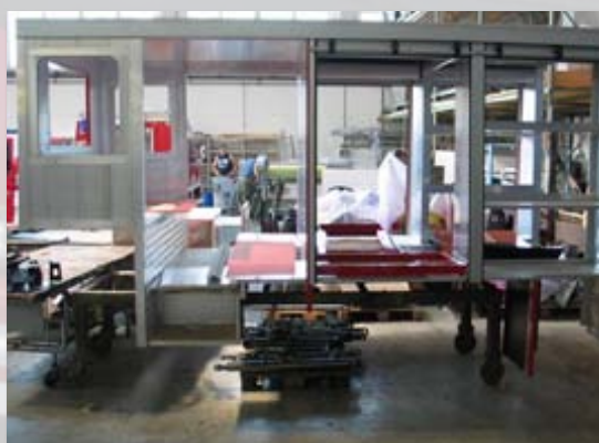
linker und rechter Ring - der feuerwehrtechnische Aufbau in der Endstehungsphase
