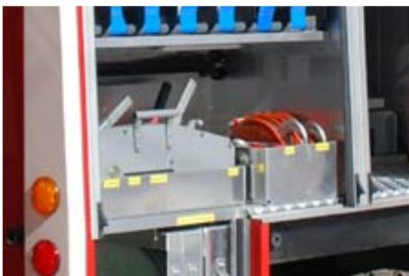
Zubehör wie Seile, Bergeschlaufen, Schäkelgehaltert, Tauchpumpe und Motorsäge ergänzen das Ausrüstungssortiment.
