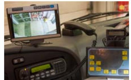
Zur Unterstützung des Kraftfahrers verfügt das LFBA über eine Rückfahrkamera, welche die Arbeit des Lenkers besonders in der Nacht wesentlich erleichtert.
